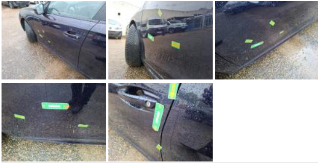
Porte ARG, Bosse(s) et griffe(s), LI - Réparer et peindre (complet)
