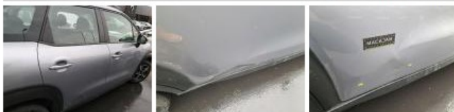
Garnit. bas de caisse ext D, Griffe(s), E - Remplacer
