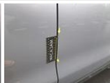
Coin pare-chocs ARG, Dégrafé, Dépose/Répose
