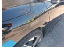
Aile ARD, Bosse(s) et griffe(s), LI - Réparer et peindre (complet)
