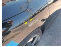
Aile ARD, Bosse(s) et griffe(s), LI - Réparer et peindre (complet)
