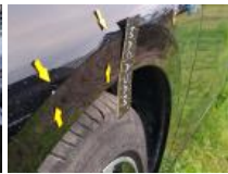
Aile AVG, Bosse(s) et griffe(s), LI - Réparer et peindre (complet)
