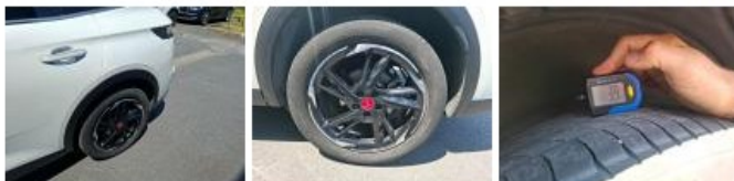
Pneu ARD, Hors tolérance, E - Remplacer
