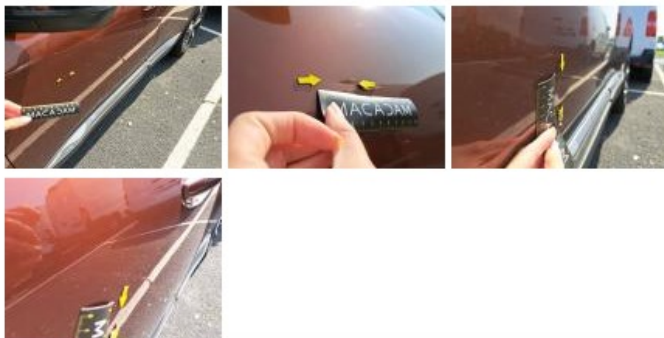
Aile ARG, Bosse(s) et griffe(s), LI - Réparer et peindre (complet)
