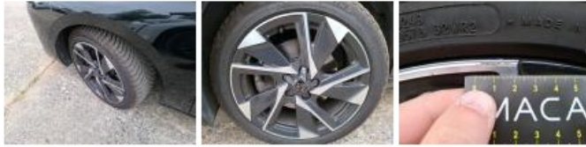
Pneu ARD, Hors tolérance, E - Remplacer
