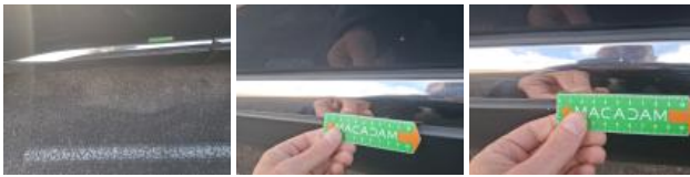
Moulure de pare-chocs AVD, Cassé, Le - Remplacer et peindre
