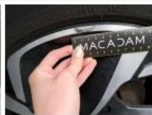
Pneu ARG, Hors tolérance, E - Remplacer
