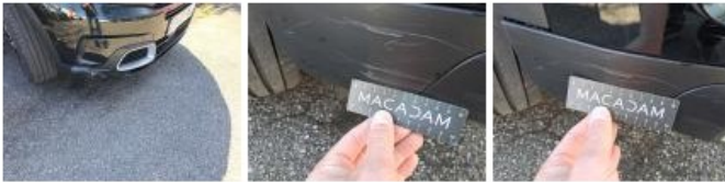
Moulure de pare-chocs AVD, Griffe(s), E - Remplacer
