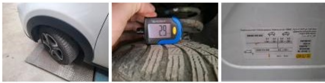
Pneu AVD, Hors tolérance, E - Remplacer
