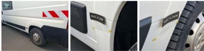
Moulure de montant milieu G, Manque, E - Remplacer
