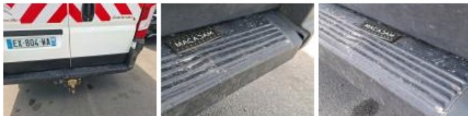
Pare-chocs AR, Déformé / Forcé, E - Remplacer
