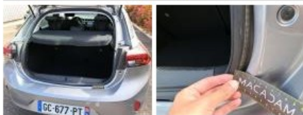
Joint de coffre, Dégrafé, N - Dépose/Répose
