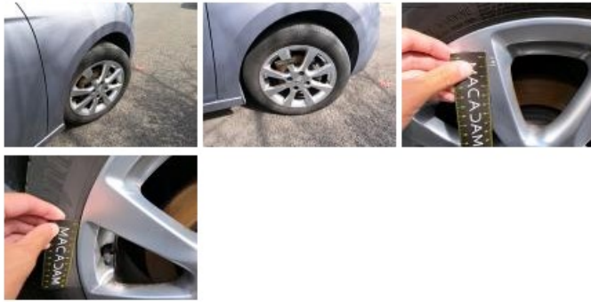
Pneu AVD, Déchirure, E - Remplacer
