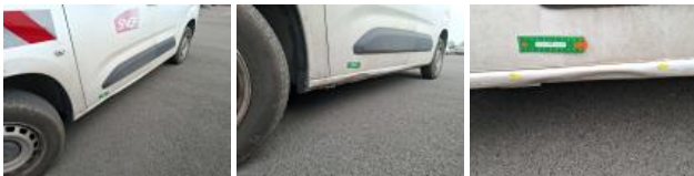
Panneau ARG, Bosse(s), LI - Réparer et peindre (complet)
