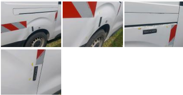
Bas de caisse ext D, Bosse(s) et griffe(s), Le - Remplacer et peindre
