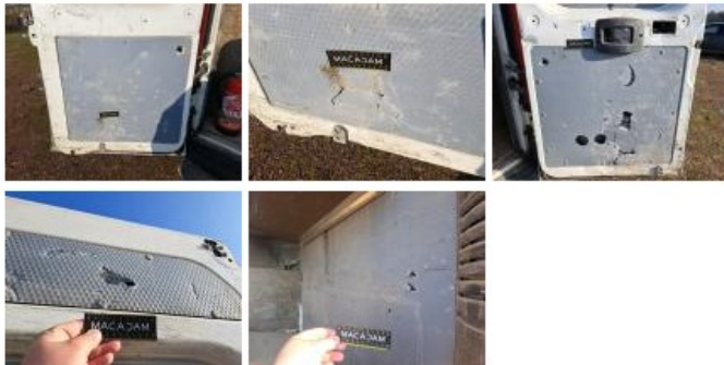
Revêtement assise AR, Brûlé, E - Remplacer
