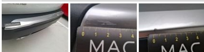
Moulure de pare-chocs AR, Griffe(s), Acceptable
