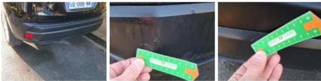
Pare-chocs AR, Griffes, Réparer/rempl. (montant forfaitaire)
