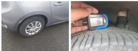
Pneu AVD, Hors tolérance, E - Remplacer
