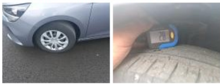
Pneu ARD, Hors tolérance, E - Remplacer
