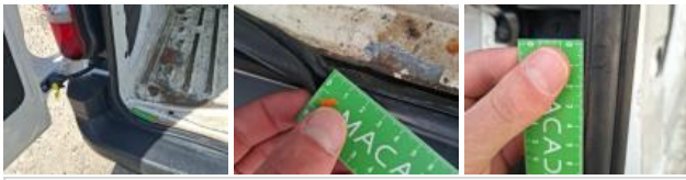
Pare-chocs AR, Déformé / Forcé, E - Remplacer
