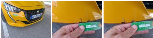
Pare-chocs AV, Déformé / Forcé, Peindre
