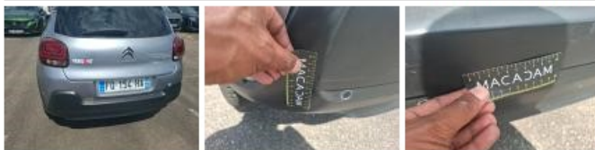
Moulure de pare-chocs ARD, Griffe(s), E - Remplacer
