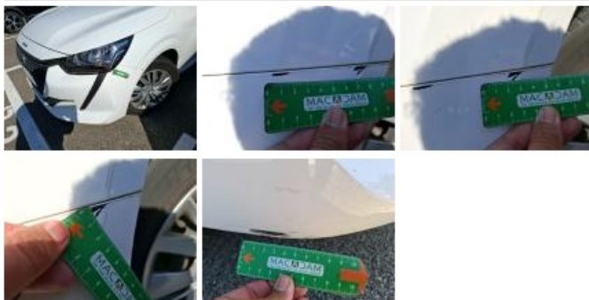
Pare-chocs AR, Fêlure, Le - Remplacer et peindre
