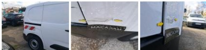
Moulure porte ARD, Griffe(s), E - Remplacer
