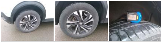
Pneu ARG, Hors tolérance, E - Remplacer
