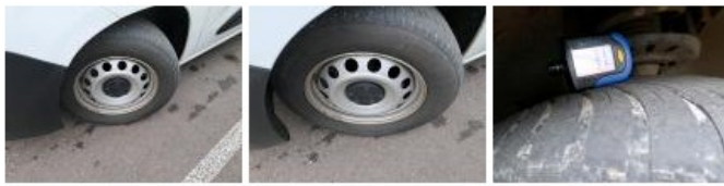
Pneu AVD, Hors tolérance, E - Remplacer
