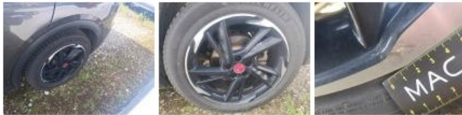
Pneu AVD, Hors tolérance, E - Remplacer
