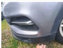
Moulure de pare-chocs AVG, Griffes(s), E - Remplacer
