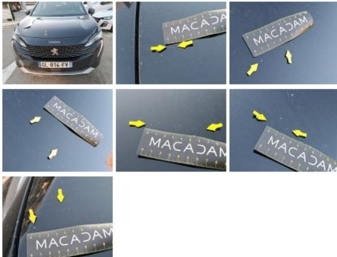
Pare-brise, Dégâts chimiques, Acceptable
