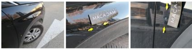
Moulure d'aile AVD, Griffe(s), Réparer/rempl. (montant forfaitaire)
