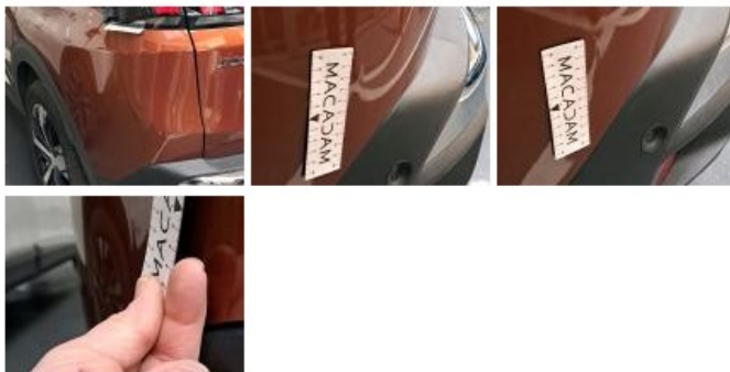
Pare-chocs AR, Griffe(s), E - Remplacer
