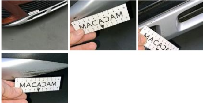
Moulure de pare-chocs AVG, Griffe(s), E - Remplacer
