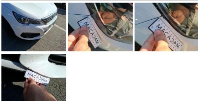
Moulure de pare-chocs AVG, Dégrafé, Dépose/Répose
