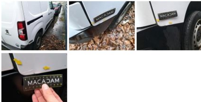
Boitier rétroviseur ext D, Cassé, E - Remplacer
