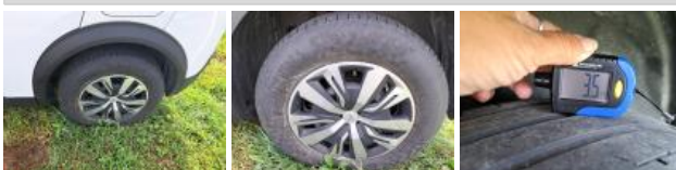
Pneu AVD, Hors tolérance, E - Remplacer
