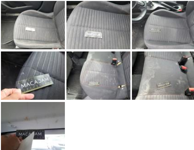
Revêtement assise siège AVG, Brûlé, Smart repair
