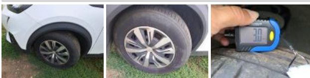
Pneu ARG, Hors tolérance, E - Remplacer
