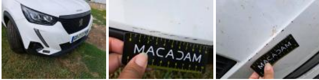
Spoiler AV, Griffe(s), E - Remplacer
