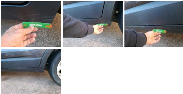
Moulure porte ARG, Griffe(s), E - Remplacer
