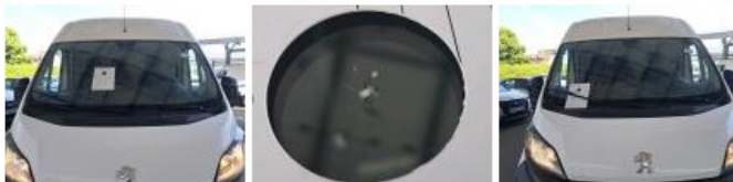
Pare-brise, Eclat(s), Réparation pare-brise 2 éclats
