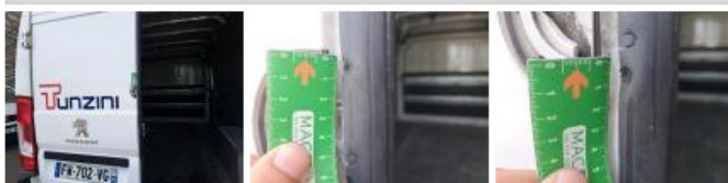
Joint de porte AR, Déchirure, E - Remplacer
