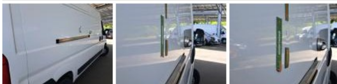
Joint de porte AR, Déchirure, E - Remplacer
