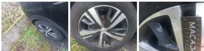
Pneu AVD, Hors tolérance, E - Remplacer
