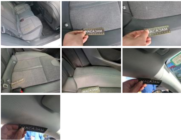
Revêtement assise siège AVG, Déchirure, E - Remplacer
