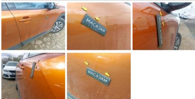
Moulure d'aile AVD, Griffe(s), Réparer/rempl. (montant forfaitaire)
