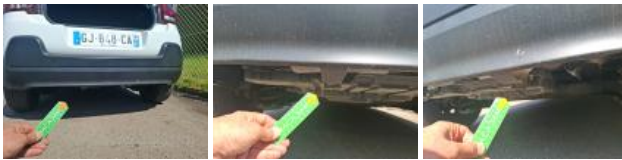
Pare-chocs AR, Cassé, E - Remplacer
