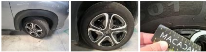
Pneu AVG, Hors tolérance, E - Remplacer
