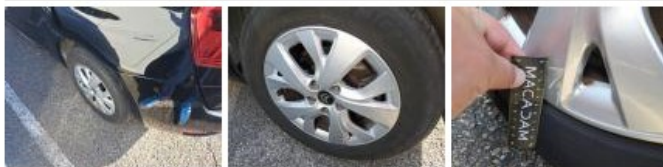
Jante alum. ARD, Griffe(s), E - Remplacer
