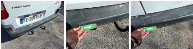
Coin pare-chocs ARD, Cassé, LI - Réparer et peindre (complet)
