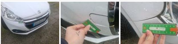
Moulure de pare-chocs AV, Cassé, E - Remplacer
