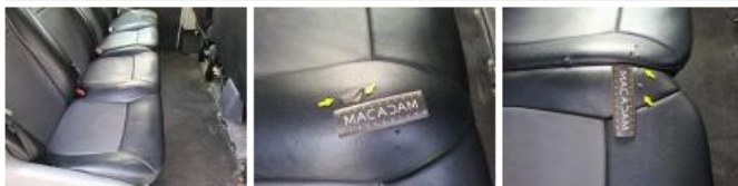
Revêtement assise ARG, Déchirure, E - Remplacer
