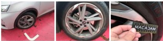
Moulure de pare-chocs AVG, Dégrafé, Dépose/Répose
