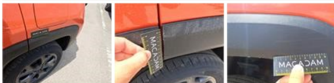
Aile ARD, Bosse(s) et griffe(s), LI - Réparer et peindre (partiel.)
