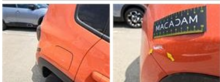
Porte AVD, Bosse(s), LI - Réparer et peindre (partiel.)
