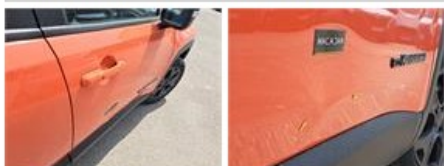
Porte AVD, Bosse(s), LI - Réparer et peindre (partiel.)
