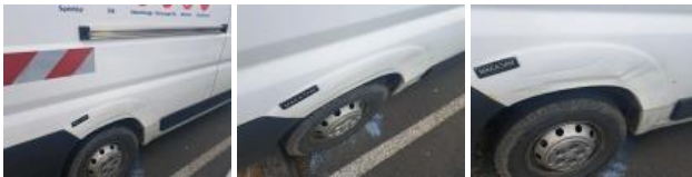
Moulure de panneau latéral D, Cassé, E - Remplacer
