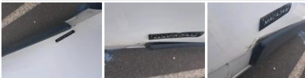
Joint de porte AR, Dégrafé, Dépose/Répose
