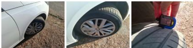
Enjoliveur de roue AVD, Cassé, E - Remplacer
