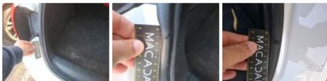
Joint de coffre/hayon, Déchirure, E - Remplacer
