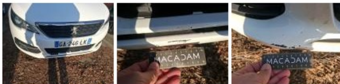
Grille de pare-chocs AV M, Dégratée, Dépose/Répose
