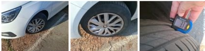
Pneu AVD, Hors tolérance, E - Remplacer
