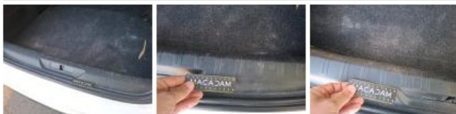
Joint de coffre/hayon, Déchirure, E - Remplacer
