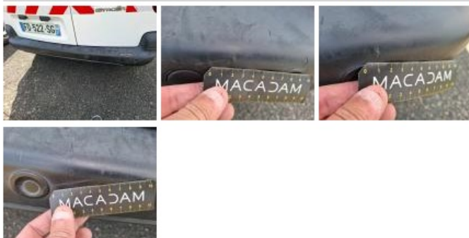
Coin pare-chocs ARD, Dégrafé, Dépose/Répose
