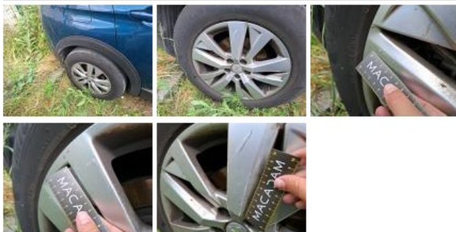
Pneu ARD, Hors tolérance, E - Remplacer
